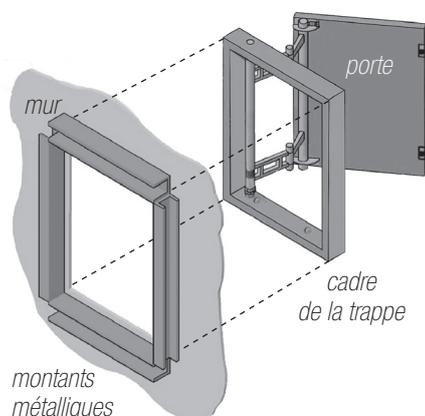
1 - Sur le mur, tracer l'emplacement de la trappe. Faire une ouverture dans le mur aux dimensions de la trappe. Pour de grandes trappes, la taille de cette ouverture sera supérieure de 2 à 3 cm aux dimensions de la trappe elle-même. Cet écart est nécessaire pour une fixation plus fiable de la trappe avec une mousse expansive.
